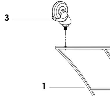
Sujete las ruedas con la tuerca grande (B). Para mantener los soportes nivelados, asegúrese de que el perno de la rueda no supere la tuerca grande.
