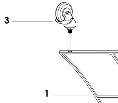
Fixez les roulettes avec les grands écrous (B). Pour garder les pieds du support à niveau, assurez-vous que le boulon de la roue ne dépasse pas du grand écrou.
