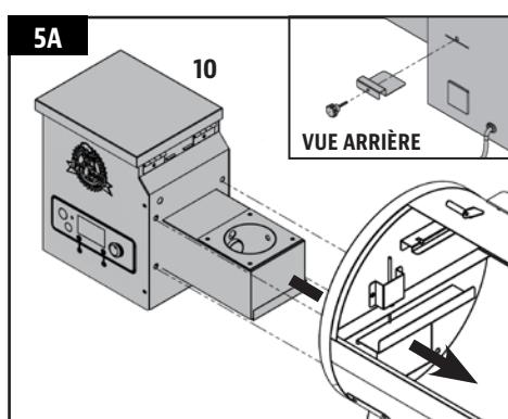
principal, depuis l'intérieur du baril, à l'aide de quatre vis, rondelles de blocage et rondelles. **Veillez à ne pas trop serrer pour éviter de dévisser les vis.** Note illustration 5A.
